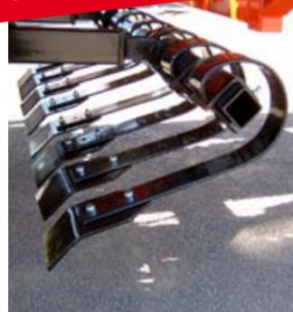
Гидравлически управляемая выравнивающая планка в дополнительной комплектации
