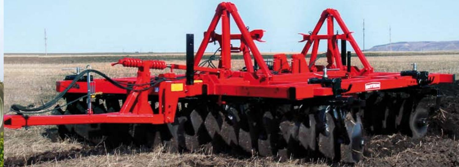
Идеальное орудие для обработки целинных и залежных земель, разрушения плужной подошвы. Прицепные дисковые бороны APVRS выпускаются в V-образной модификации, шириной захвата от 5 / 6 / 7 / 8 / 9 метров, складываются полностью гидравлически и автоматически переводятся в транспортное положение.
