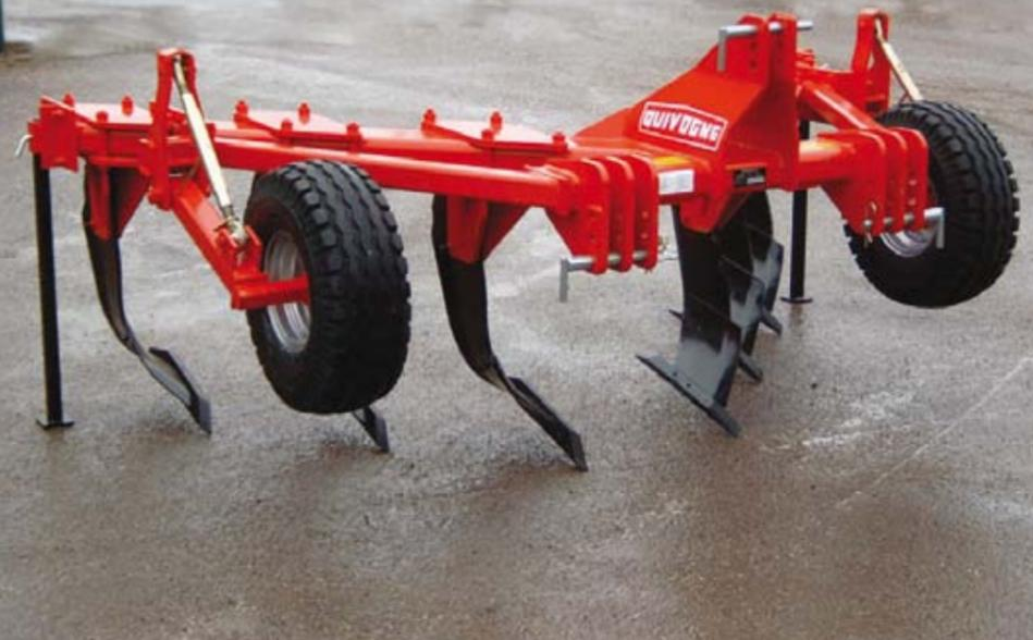
За счет специальной формы лемехов и направляющих щитков глубокорыхлителя SSD разбиваются уплотнения в почве, а изогнутая форма лап предотвращает смешивание ее отдельных слоев. Лапы высотой 900 мм полосовидно разбивают почву, разрушая подплужную подошву, производя рыхление и аэрацию пахотного и подпахотного горизонта
