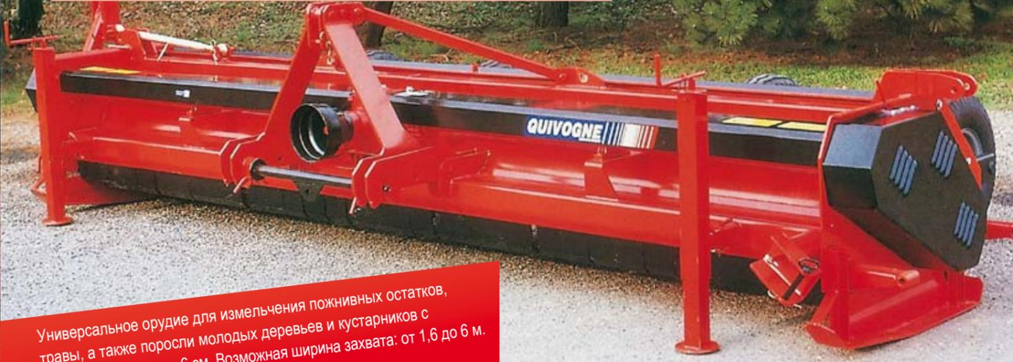
Универсальное орудие для измельчения пожнивных остатков, травы, а также поросли молодых деревьев и кустарников с диаметром ствола до 6 см. Возможная ширина захвата: от 1,6 до 6 м. Комплектация различными видами ножей:
