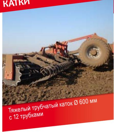
Тяжелый трубчатый каток Ø 600 мм с 12 трубками
