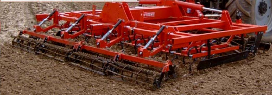
Агрегат для подготовки превосходно разрыхленного, обработанного на одинаковую глубину и обратно уплотненного посевного ложа, особенно рекомендуемый при выращивании сахарной свеклы, кукурузы, подсолнечника
