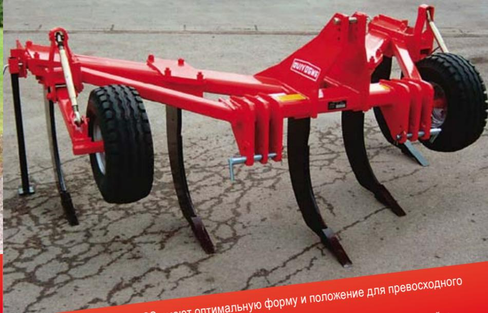
Лапы глубокорыхлителя SS имеют оптимальную форму и положение для превосходного внедрения в почву, экономящего энергозатраты. Возможны два варианта комплектации лапами высотой 750 мм и 900 мм. Надежный и прочный агрегат, способный выдерживать высокие нагрузки и обрабатывать любой тип грунта в том числе и каменистый.
