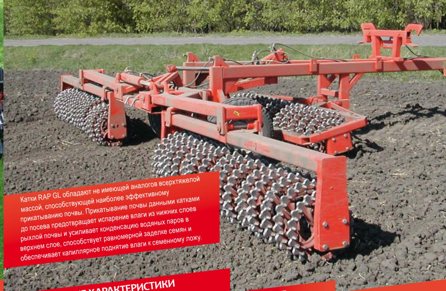
Катки RAP GL обладают не имеющей аналогов всерхтяжелой массой, способствующей наиболее эффективному прикатыванию почвы. Прикатывание почвы данными катками до посева предотвращает испарение влаги из нижних слоев рыхлой почвы и усиливает конденсацию водяных паров в верхнем слое, способствует равномерной заделке семян и обеспечивает капиллярное поднятие влаги к семенному ложу.
