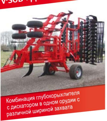
Комбинация глубокорыхлителя с дискатором в одном орудии с различной шириной захвата
