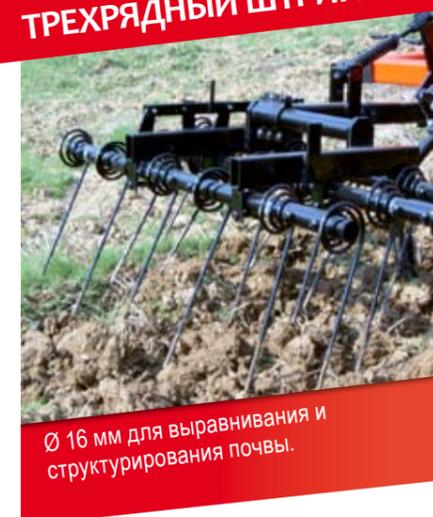
Ø 16 мм для выравнивания и структурирования почвы.
