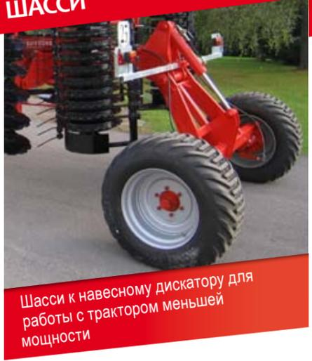
Шасси к навесному дискатору для работы с трактором меньшей мощности
