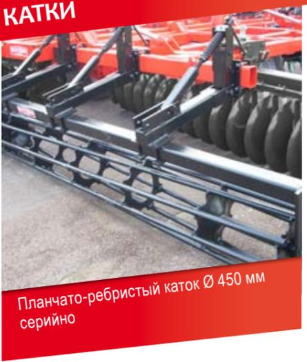
Планчато-ребристый каток Ø 450 мм серийно
