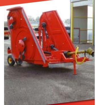
Складываются гидравлически на ширину менее 2,9 м
