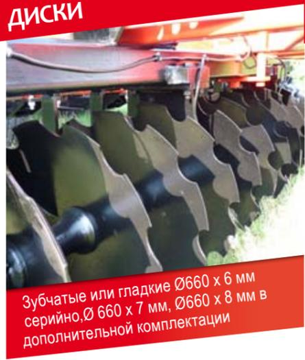
Зубчатые или гладкие Ø660 x 6 мм серийно, Ø 660 x 7 мм, Ø660 x 8 мм в дополнительной комплектации
